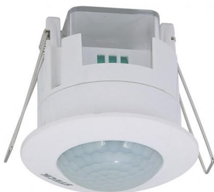
DETECTOR sensor de movimento de encastrarem policarbonato branco. Tem um alcance de 6 metros e um ângulo de detecção de 360 graus. As suas dimensões são 7,3x7,6x7,6 centímetros, com um diâmetro de corte de 6,1 centímetros e um peso líquido de 80 gramas. Tem um índice de protecção IP20.
