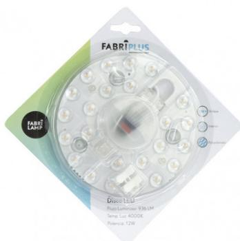
Disco LED de 12 watts da série PLACA com uma temperatura de luz de 4000°K, branco natural e 936 lúmenes. Feito de metal e policarbonato. Fonte de luz com TECNOLOGIA DE LED INTEGRADA para substituir ou reparar downlights, luzes de tecto, spotlights, etc. Não regulável. As suas dimensões são de 13x13x2,5 centímetros. Disponíveis nesta série os discos de LED de 24 e 12 watts, com luz quente, branco natural ou branco frio, nos seus respectivos tamanhos, e também magnéticos.
