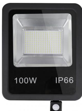
Projector da série Série OLIVINO com sensor de movimento em cor PRETO. Fabricado em alumínio, vidro e policarbonato. O sensor é articulado de modo a poder ser orientado com uma mobilidade de 360° para a área de maior interesse. Tem uma potência de 100 watts e 9000 lumens, com uma temperatura de luz de 6500°k (luz fria). As suas dimensões são de 39,5x28,5x7 centímetros . Com uma protecção IP66 Classificação de protecção IP66, tornando-a resistente ao pó e à água.
