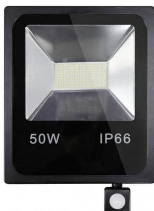
Projector da série Série OLIVINO com sensor de movimento em cor PRETO. Fabricado em alumínio, vidro e policarbonato. O sensor é articulado de modo a poder ser orientado com uma mobilidade de 360° para a área de maior interesse. Tem uma potência de 50 watts e 4500 lumens, com uma temperatura de luz de 6500°k (luz fria). As suas dimensões são de 33,5x24x6 centímetros. Com uma protecção IP66 Classificação de protecção IP66, tornando-a resistente ao pó e à água.
