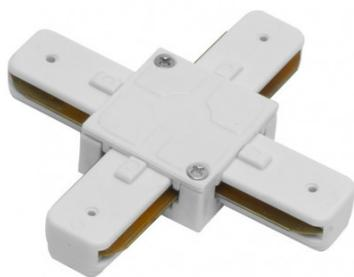
Conector da série PINDAL em forma de "X" para projectores de pistas em cor branca. Feito de alumínio e policarbonato. A sua ligação é de dois fios e permite a ligação de 4 carris ao mesmo tempo. As suas dimensões são 1,5x9,5x9,5 centímetros. A sua utilização é recomendada para interiores. Também disponível em preto.
