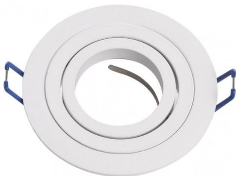
Luminária de encastrar regulável série CENOTE com forma redonda, em cor BRANCA. Feito de alumínio. As suas dimensões são 2x9,2x9,2 centímetros. Corte para instalação de 8 centímetros. Tem um suporte para lâmpadas GU10. Lâmpada não incluída. Design moderno, com uma grande variedade de combinações de cores nesta série, tais como Champanhe/Cromo, Alumínio/Cromo, Wenge/Cromo, Branco/Cromo, Couro e Branco. Também disponível em forma quadrada, adaptando-se ao que melhor se adequa à sua decoração.
