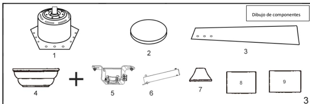
1. Motor 2. embellecedor 3. aspa 4. Embellecedor 5. Soporte de montaje 6. Pletina 7. Tapa del conector 8. accesorios 9. Aspas
