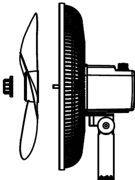
3. Tome la rejilla frontal y colóquela sobre la rejilla trasera. Asegúrese de alinear correctamente las pestañas y luego fíjela con los tornillos de seguridad.
