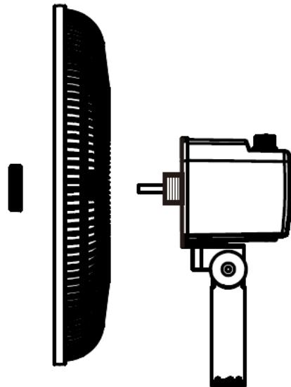
2. Las aspas se instalan en el eje giratorio del motor, y se debe prestar atención a la alineación de la muesca interna de las aspas con la posición del pasador del eje del motor.
