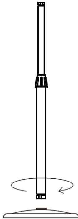
5. Instale la parte superior ya montada dentro del tubo extensible, prestando atención a una marca triangular en el tubo interno de la columna. Alinee la marca de desbloqueo en la horquilla e insértela en el chasis girando 90° en el sentido horario.
