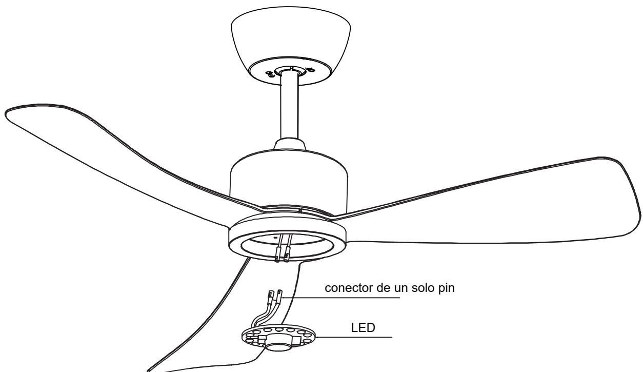
Inserte los conectores de los cables de la lámpara LED según el mismo color.
