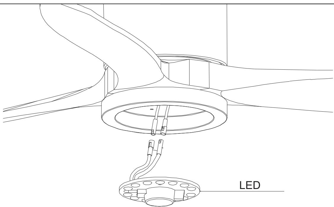
Inserte los conectores de los cables de la lámpara LED según el mismo color.
