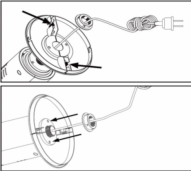
4. Asegure el cuerpo principal y la base girando la tuerca de plástico ajustable en sentido horario.
