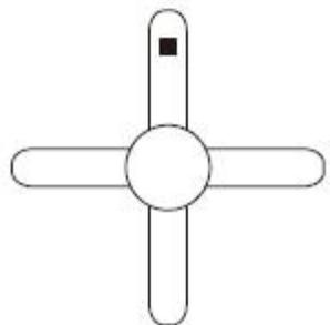
Pegar el contrapeso a la altura del clip en la superficie de la pala, quitar el clip y probar el ventilador, si sigue oscilando poner otro contrapeso, si en lugar de mejorar empeora probar en otra zona del ventilador.
