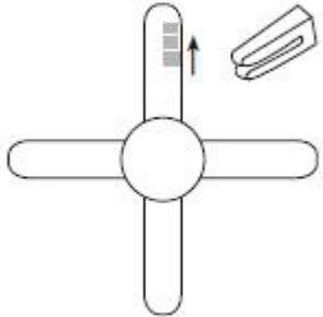
Colocar el clip en la pala que necesita el contrapeso, hay que comprobar cuál es el mejor sitio para colocarlo, por lo que hay que empezar en el centro de la pala e ir moviendo el clip hacia el final de esta, hasta que desaparezca el bamboleo.
