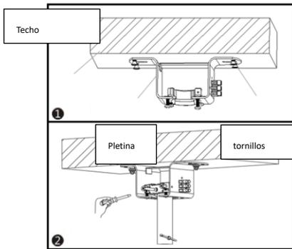
1. No coloque el soporte directamente sobre la madera contrachapada del techo para evitar que los tornillos de madera se aflojen causado un accidente.
