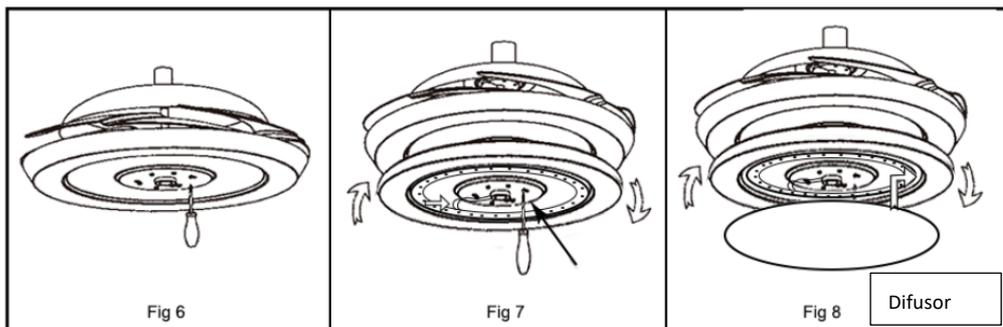
**Atención: compruebe si los tornillos de conexión entre la lámpara y el motor están apretados**
