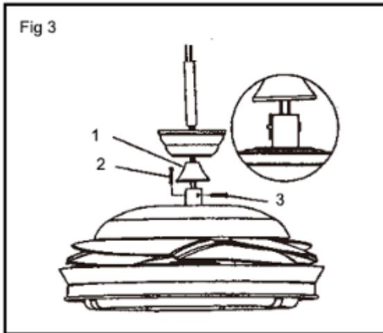
1. Retire el pasador R y el perno transversal, pase el suspensor a través del embellecedor y la cubierta de la junta, luego inserte el suspensor en el cabezal de elevación y alinee el orificio con el orificio. Luego inserte el pasador, inserte el pasador R a través del orificio del pasador y luego bloquee los tornillos en el costado del cabezal de elevación. (Fig 3)
