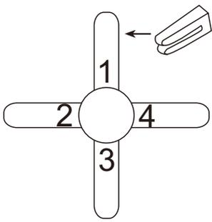
Poner el clip en el centro de una pala, encender el ventilador, si la oscilación persiste, cambiar el clip a otra pala y así hasta encontrar la pala que reduzca el bamboleo, en esta pala será en la que haya que colocar el contrapeso.
