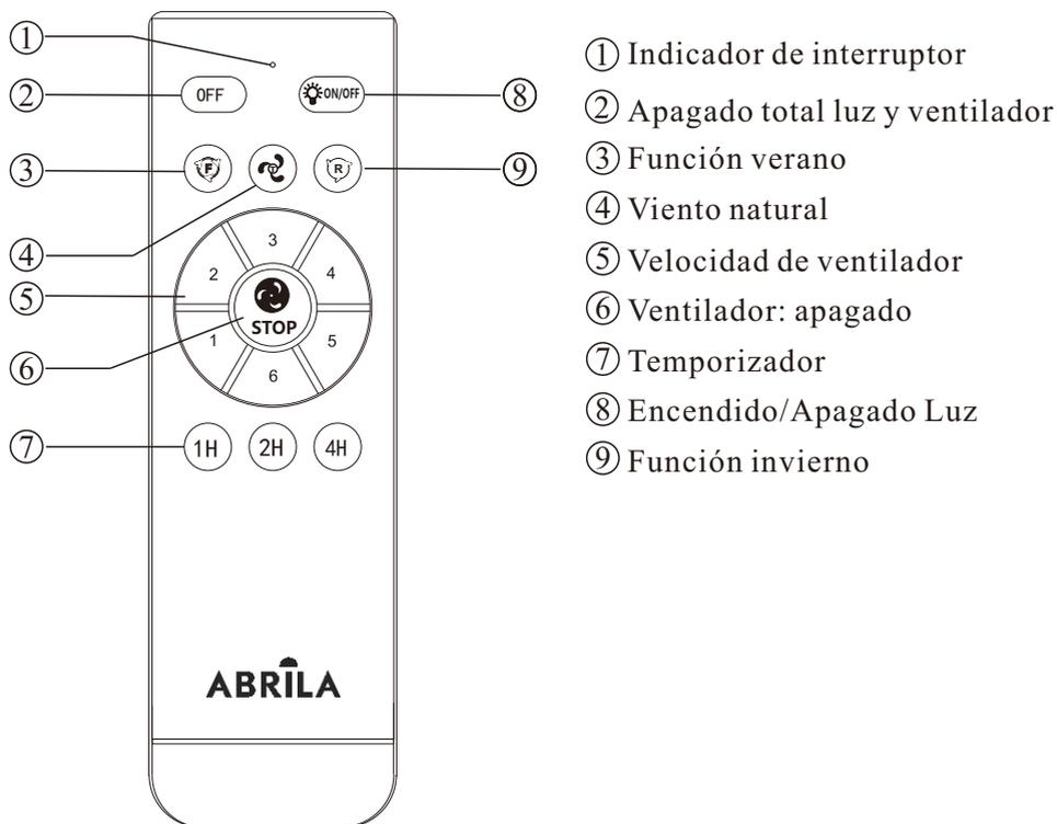
Los mandos están debidamente sincronizados con el ventilador cuando salen de fábrica, por lo que una vez correctamente instalados deben de funcionar. Si hay que reemplazar el mando por algún motivo, si sería necesario sincronizarlo con el ventilador.
