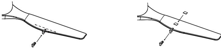
Poner el clip en el centro de una pala, encender el ventilador, si la oscilación persiste, cambiar el clip a otra pala y así hasta encontrar la pala que reduzca el bamboleo, en esta pala será en la que haya que colocar el contrapeso.
