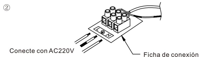
luego conecte los cables, asegúrese de que el cable de cobre no esté expuesto y atornille el cuerpo de la lámpara en el tornillo de la placa, asegúrese de que la instalación sea firme.
