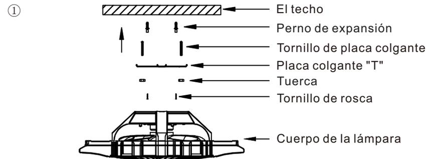
Desconecte el interruptor antes de la instalación. Dar una buena distancia a los agujeros de la placa, el tornillo de expansión en el techo, bloquear la placa colgante, para asegurar que la instalación sea fuerte.
