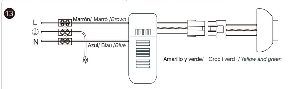
**Hacer las conexiones para el receptor remoto entre los cables que vienen del motor y los que vienen de la vivienda tal y como se muestra en el esquema.**
