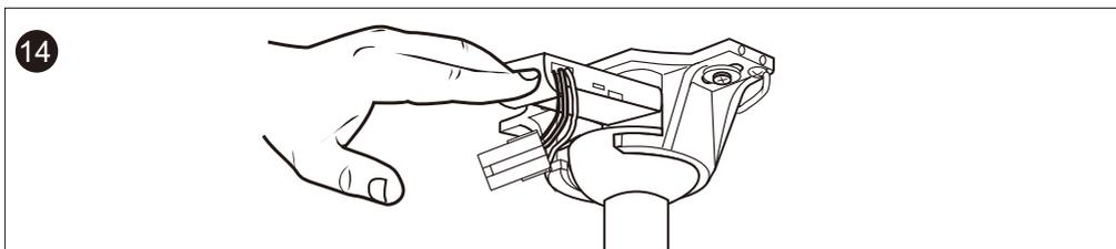
Una vez que se ha hecho el cableado, insertar el receptor remoto ya cableado dentro del soporte, entre la estructura de montaje y la bola de suspensión.
