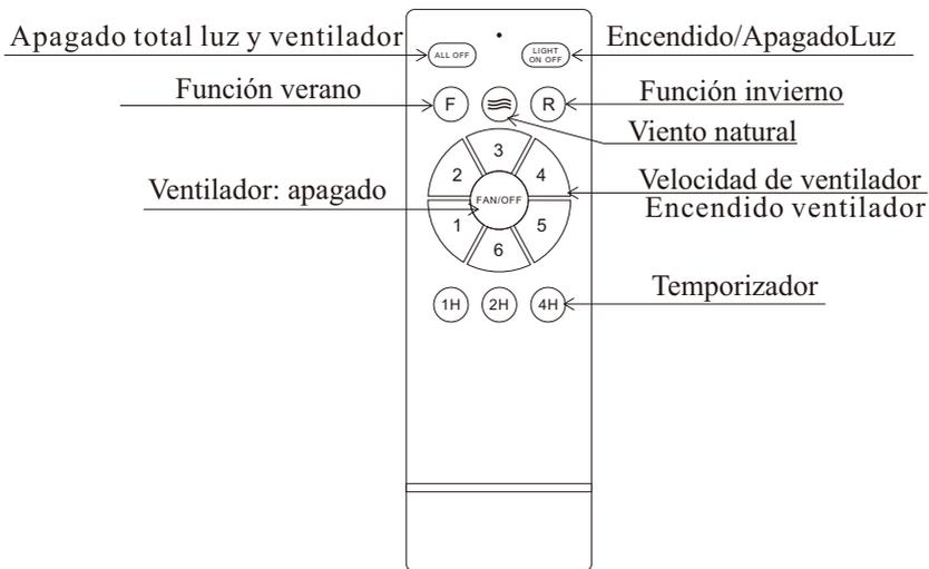
Los mandos están debidamente sincronizados con el ventilador cuando salen de fábrica, por lo que una vez correctamente instalados deben de funcionar. Si hay que reemplazar el mando por algún motivo, si sería necesario sincronizarlo con el ventilador.
