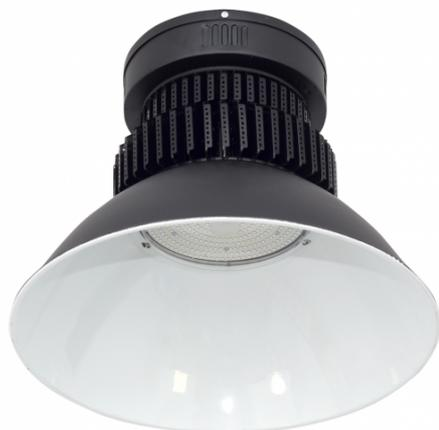
Campana reflectora LED con 200w de potencia, 6500<sup>o</sup>k de color de luz. Sus medidas son 46x47x47 cm. Su uso es de interior y su instalación en superficie.
