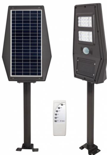
Farola solar de color gris. Posee 12 W de potencia, 1300 lúmenes y 6400K de color de luz. Se activa mediante el sensor de movimiento o crepuscular. Incluye vástago de metal, kit de instalación y mando a distancia programable para su apagado en 4, 6 y 8 horas o de manera automática y manual. Las medidas son 85x27x8 cm (farola+vástago). IP65.
