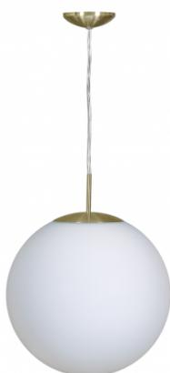
Colgante serie global en color blanco /oro. Tulipa de cristal opal de 20 centímetros de diámetro, montura extensible de color oro con un portalámparas E27 y cable transparente de aproximadamente 100 centímetros de longitud. La fijación al techo, se realiza mediante pletina metálica, tacos de plásticos y dos tornillos. Este colgante tiene un peso de 850 gramos.
