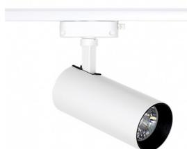
Foco carril serie ADONIS realizado en aluminio color Blanco con iluminación LED INTEGRADA. Su potencia de luz es de 35 vatios, 2200 lúmenes y 2700 K. Tiene una medida de 21x8d centímetros. Foco con sistema de carril monofásico, como todos nuestros focos y carriles. Es orientable 360° y posee una apertura de luz de 36°.
