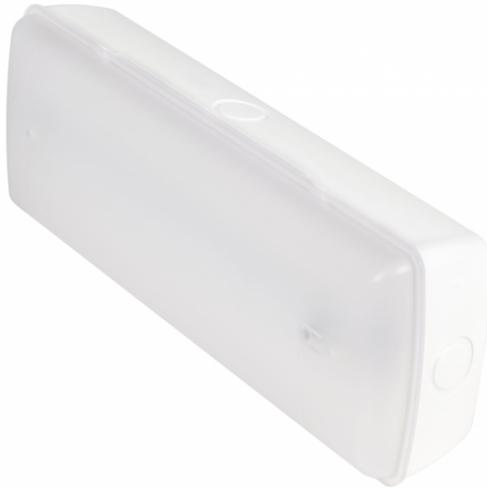
Luz de emergencia KANATA con luz PERMANENTE o no PERMANENTE. Tiene una potencia de luz de 3 watos, 80 lúmenes y 4000K, con batería de 3 horas. Su medida es de 26X9,5X5 centímetros y un peso neto de 250 gramos. Índice de protección IP30. Posee la opción de acoplar un telecomando. Incluye dispositivo **Autotest** que permite verificar el buen funcionamiento del aparato mientras permanece apagado. Con este sistema se previene incidencias en caso de emergencia.
