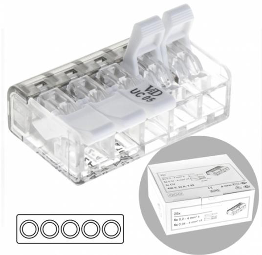
Ficha de conexión de cinco polos de 0,2-4 mm. Posee un potencia de 450 V y 32 amperios. Admite los cables mostrados en la imagen. Realizado en policarbonato.
