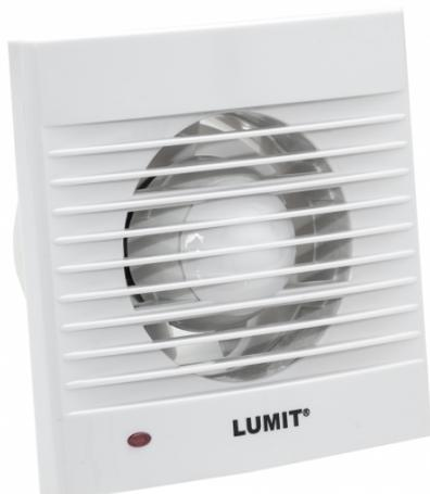
Extractor GRAVANA de 12W de potencia en color Blanco. Este modelo se recomienda par tubos de 10 cm. Realizado en un material ligero como el policarbonato, ofrece un indice muy bajo de ruido entre 40-45 decibelios y un flujo de aire de 120 metros cúbicos. Además ofrece la posibilidad de adaptar un temporizador (Ref. 99.VOOXTEMP) que permite definir el tiempo de funcionamiento de éste, incluso después de apagar la luz.
