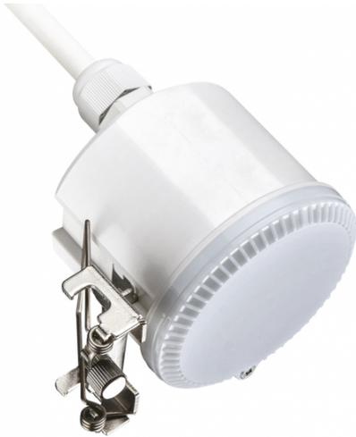
Sensor de Movimiento y crepuscular MOVE VII con un alcance de 4-10 metros, con REGULADOR DE LUZ. Es un complemento magnifico para campanas industriales. Su ángulo de alcance es de 360°. Tiene un índice de protección de IP65. Realizado en policarbonato. Tiene unas dimensiones de 6x7x7 centímetros.
