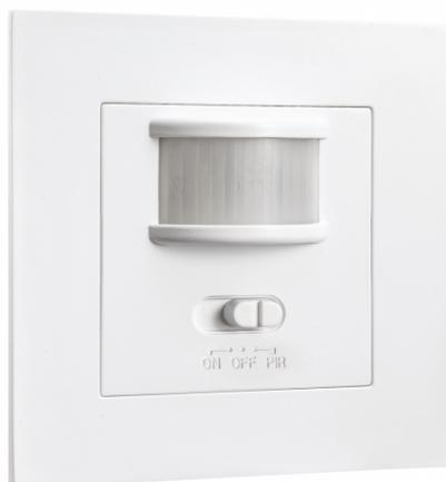
Sensor de movimiento de encastrar MOVE VI. Posee también un sensor de infrarrojos que permite captar la radiación que emite el calor de los cuerpos en movimiento. Con un índice de protección de IP20, puede detectar movimiento hasta a 9 metros de distancia, con un campo de detección de 160°. Está realizado en aluminio y policarbonato. Tiene un interruptor de ON/Off y es regulable en tiempo e intensidad. Tiene una medida de 8,2x8,2x5 centímetros con 7x7 centímetros de corte para su instalación.
