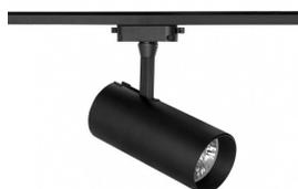
**Foco carril serie ADONIS** realizado en aluminio color negro con iluminación **LED INTEGRADA**. Su potencia de luz es de 15 vatios, 1400 lúmenes y 4000 K. Tiene una medida de 17x5,5 centímetros. Foco con sistema de carril monofásico, como todos nuestros focos y carriles. **Es orientable 360°** y su apertura de luz es de 36°. Realizado en materiales de gran resistencia y ligereza como el aluminio y el policarbonato.
