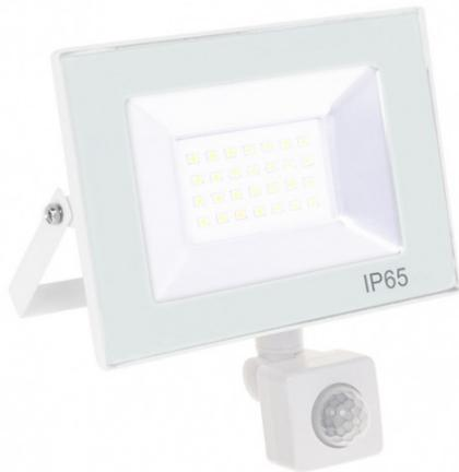
**Proyector KOLYMA con sensor de movimiento de color blanco, 30 W de potencia, 1500 lúmenes y 6500k (luz fría). Se puede regular el tiempo y la intensidad de la luz en el propio sensor el cual también es orientable. El índice de protección es IP65, resistiendo así al polvo y el agua. Sus medidas son 16x14,5 cm. LED INTEGRADO.**
