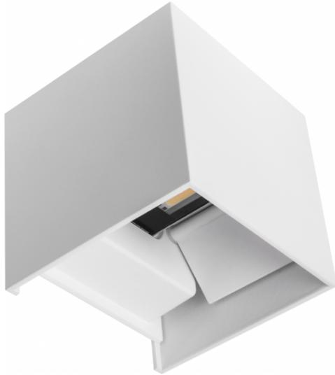
Aplique SEVER realizado en aluminio color blanco con LED INTEGRADO. Tiene unas medidas de 10X10X10 centímetros y un peso neto de 625 gramos. Su potencia de luz es de 6 watos, 660 lúmenes y 4000K. Su índice de protección es IP54. La proyección de la luz es tanto directa (hacia abajo) como indirecta (hacia arriba), con posibilidad tanto de angular la luz como de cegar una de sus salidas de luz por medio de una pestañita.
