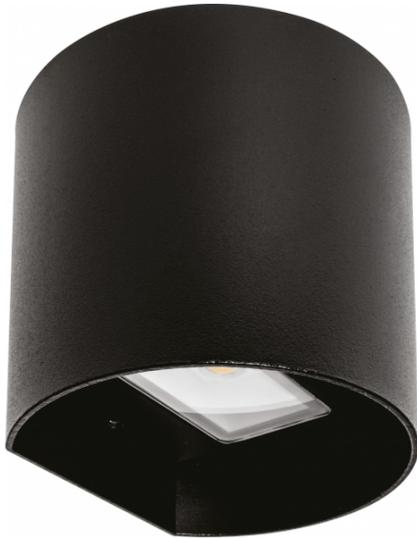
Aplique SABOR con LED INTEGRADO, realizado en aluminio color negro. Tiene una potencia de 8 watos, 650 lúmenes y 3000K. Su medida es de 9,5x11 centímetros. Índice de protección IP54.
