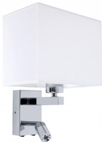
Aplique **serie Paradigma** de color cromo con pantalla en color blanco. Realizado en material textil y metal. Se caracteriza por poseer un portalámparas E27 y una pequeño módulo LED orientable de 3w de potencia y 4000°k de color natural. Destaca su forma cuadrangular tanto de la pantalla como en el cuerpo del aplique. Sus dimensiones son 29X23X19 cm. Es ideal para dormitorios decorados en tonos grises y fríos.
