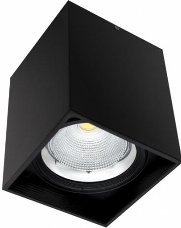
Foco CUBULAR de superficie realizado en aluminio color negro con LED INTEGRADO. Tiene una potencia de 20 vatios, 1600 lúmenes y 4000K. Su medida es de 21,6X16X16 centímetros y tiene un peso neto de 1250 gramos.
