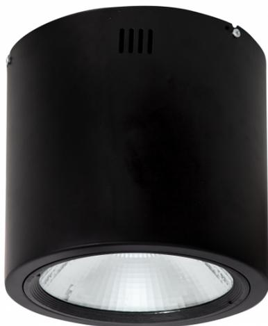
Foco TUBULAR de superficie con LED INTEGRADO de color NEGRO. Realizado en metal y policarbonato. Su potencia de luz es 20 vatios, 1600 lúmenes y 4000K, blanco natural. Tiene una medida de 18x16,3x16,3 centímetros y un peso neto de 910 gramos. En esta misma serie podemos encontrar los focos de 20, 30, 40, 50 y 60 vatios, tanto en color negro como en blanco.
