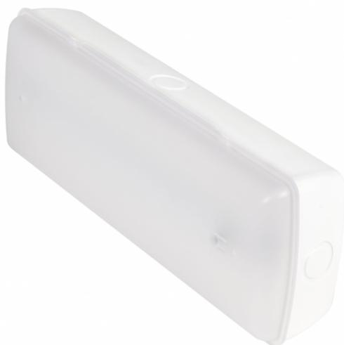
Luz de emergencia KANATA con luz PERMANENTE o no PERMANENTE. Tiene una potencia de luz de 3 vatios, 80 lúmenes y 4000K, con batería para 3 horas. Su medida es de 9,5x26x5,5 centímetros y tiene un peso neto de 250 gramos. Índice de protección IP30. Incluye dispositivo **Autotest** que permite verificar el buen funcionamiento del aparato mientras permanece apagado. Con este sistema se previene incidencias en caso de emergencia.
