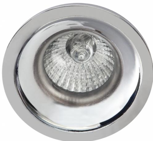
Empotrable JEROGLIFICO de color CROMO y realizado en aluminio. Posee un portalámparas GU10. Bombilla no incluida. Tiene unas medidas de 3x8,5x8,5 centímetros y un peso neto de 125 gramos, con una medida de corte de 7 centímetros de diámetro para su instalación. Modelo disponible en color cromo y plata.
