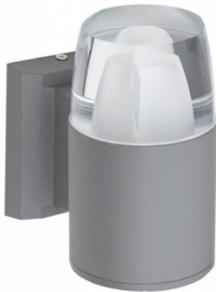
Aplique de exterior JAMAICA realizado en aluminio color gris con LED INTEGRADO. Tiene una potencia de luz de 9 watos, 720 lúmenes y 4000k (luz directa+luz indirecta). Su medida es de 15,5X15X9 centímetros y su peso neto de 720 gramos. El índice de protección es IP65.
