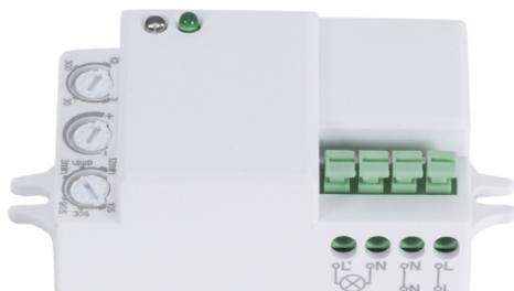
Sensor de movimiento MOVE III de largo y corto alcance. Se activa por micro-ondas encendiendo la luz con cualquier tipo de movimiento. Se apaga la luz de acuerdo al tiempo seleccionado, puede ser ajustado entre 10 segundos y 12 minutos. Su medida es de 6X3,5X2,5 centímetros y tiene un peso neto de 40 gramos.
