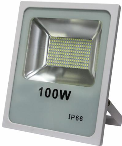
Proyector led serie QUIRON realizado en aluminio color blanco. Tiene unas medidas de 30x35x6,5 centímetros y un peso neto de 2565 gramos. Su potencia de luz es de 100 vatios, 7900 lúmenes y 4000°K. Tiene un índice de protección IP66 y un ángulo de luz de 120°.
