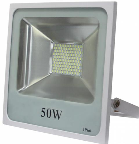
Proyector led serie QUIRON realizado en aluminio color blanco. Tiene unas medidas de 23,8x28,8x6,2 centímetros y un peso neto de 1860 gramos. Su potencia de luz es de 50 vatios, 4500 lúmenes y 4000°K. Tiene un índice de protección IP66 y un ángulo de luz de 120°.
