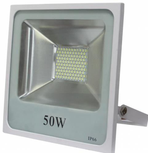
Proyector led serie QUIRON realizado en aluminio color blanco. Tiene unas medidas de 23,8x28,8x6,2 centímetros y un peso neto de 1860 gramos. Su potencia de luz es de 50 vatios, 4500 lúmenes y 6500°K. (luz fría) Tiene un índice de protección IP66 y un ángulo de luz de 120°.
