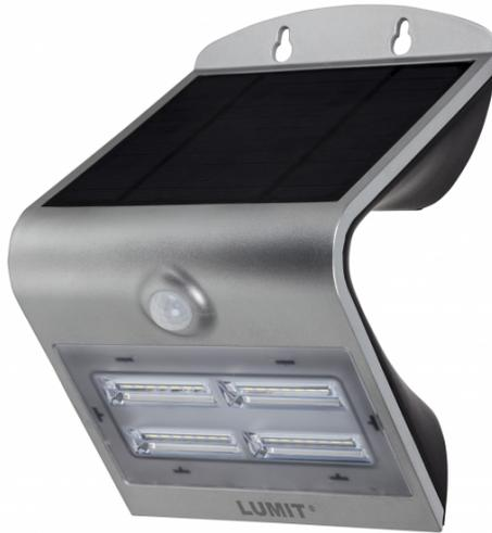
Aplique solar **Serie Solaris** en color plata. Realizado en policarbonato, posee una potencia de 3,2 W, 400 Lm, 4000°k en la parte trasera y 6000°k en la delantera. Su funcionalidad permite que el aplique se encienda tanto cuando baja la luminosidad como cuando detecta movimiento. Incluye una batería de iones de litio reemplazable. El índice de protección es IP65.
