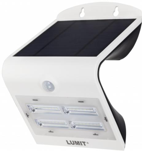
Aplique solar con sensor de movimiento y luminosidad **Serie Solaris**. Realizado en policarbonato, posee una potencia de 3,2 W, 400 Lm, 4000°k en la parte trasera y 6000°k en la delantera. Su funcionalidad permite que el aplique se encienda tanto cuando baja la luminosidad como cuando detecta movimiento. Incluye una batería de iones de litio reemplazable. El índice de protección es IP65.
