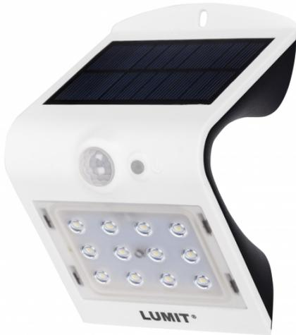
Aplique solar con sensor de movimiento y luminosidad **Serie Solaris** color blanco. Realizado en policarbonato, posee una potencia de 1,5 W, 220 Lm, 4000°k en la parte trasera y 6000°k en la delantera. Su funcionalidad permite que el aplique se encienda tanto cuando baja la luminosidad como cuando detecta movimiento. Incluye una batería de iones de litio reemplazable. El índice de protección es IP65. Es ideal para exteriores de chalets decorados en un estilo moderno.
