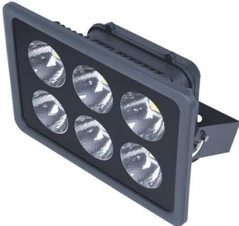
Proyector LED serie SUKRA realizado en aluminio gris oscuro y cristal. Tiene unas medidas de 32,5x45,5x18 centímetros y un peso neto de 7000 gramos. Su potencia de luz es de 300 vatios, 30.000 lúmenes y 6500K. La apertura de luz es de 75° y el índice de protección es IP66.
