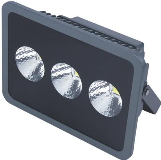
Proyector LED serie SUKRA realizado en aluminio gris oscuro y cristal. Tiene unas medidas de 28,5x38,5x18 centímetros y un peso neto de 5000 gramos. Su potencia de luz es de 150 vatios, 15.000 lúmenes y 6500K. La apertura de luz es de 75° y el índice de protección es IP66.
