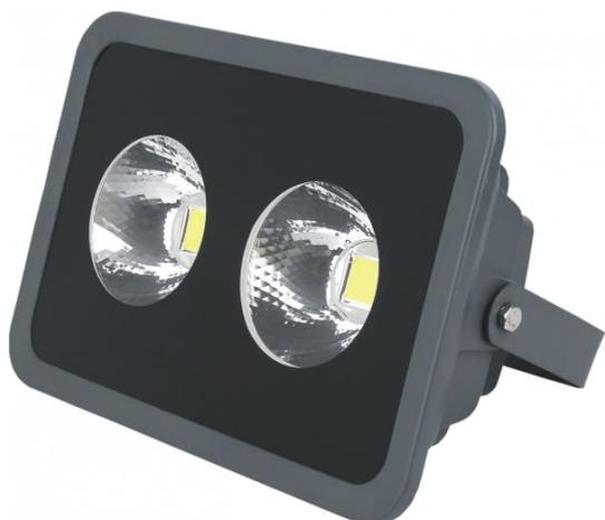
Proyector LED serie SUKRA realizado en aluminio gris oscuro y cristal. Tiene unas medidas de 23,5x33,5x15 centímetros y un peso neto de 3000 gramos. Su potencia de luz es de 100 vatios, 10.000 lúmenes y 6500K. La apertura de luz es de 75° y el índice de protección es IP66.
