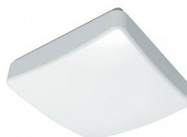
Plafón cuadrado con SENSOR modelo SURF de iluminación LED INTEGRADA. Realizado en metal y policarbonato color blanco. Su potencia de luz es 22 vatios, 2200 lúmenes y 4000K. El sensor tiene un alcance de 8 metros con 360° de apertura. Tiene unas medidas de 6,5x37x37 centímetros y un peso neto de 840 gramos. Índice de protección IP20.
