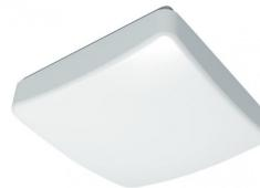
Plafón cuadrado con SENSOR modelo SURF de iluminación LED INTEGRADA. Realizado en metal y policarbonato color blanco. Su potencia de luz es 18 vatios, 1800 lúmenes y 4000K. El sensor tiene un alcance de 8 metros con 360° de apertura. Tiene unas medidas de 6,5x32x32 centímetros y un peso neto de 650 gramos. Índice de protección IP20.
